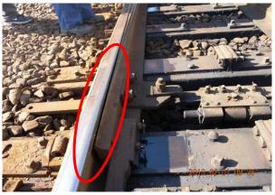
照片 3:列車行經 709B 號轉轍器定位路徑因 照片 4:列車行經 709B 號轉轍器定位路徑因中途扳 中途扳轉為反位致被車輛擠壓後,肇 致調整桿彎曲。
