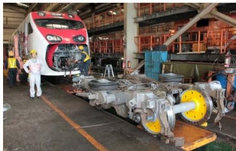
圖 15 PQ 測定軸更換安裝完成
