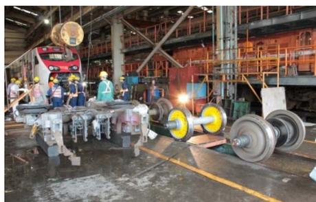
圖 14 PQ 測定軸更換
