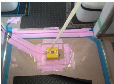
圖 18 車廂地板安裝加速計
