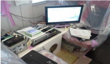
圖 27 集電舟追隨性能監視設備
