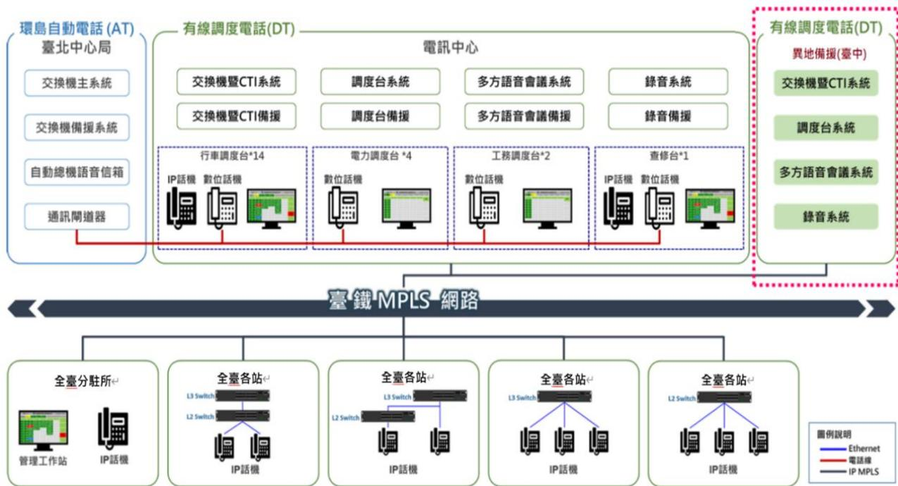
圖三、有線調度電話系統架構圖
