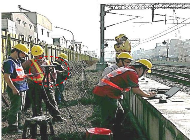
圖 6 現地噪音計架設照片
