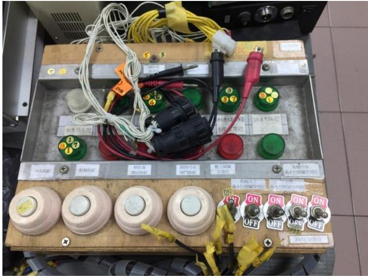
圖 7 太魯閣自強號廁所 PLC 控制器測試平台
