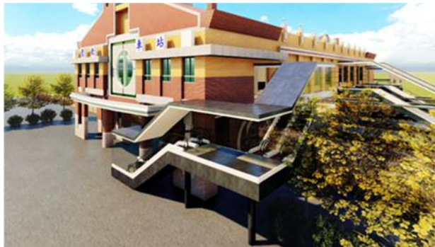
鶯歌站建國路、文化路兩側站體 增設電扶梯
