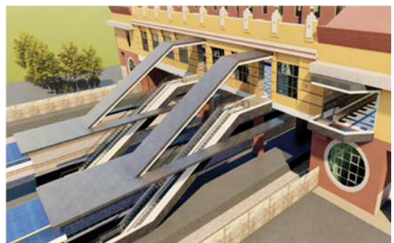
鶯歌站月台南端增設電扶梯
