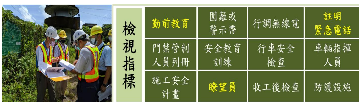
圖 1 臺鐵臨軌在建工程 12 項檢視項目
