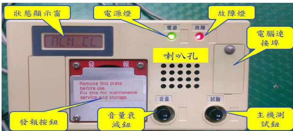
圖 2 列車防護無線電移動台設備示意圖(前端)
