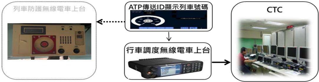
圖 18 無線電系統整合車上架構示意圖
