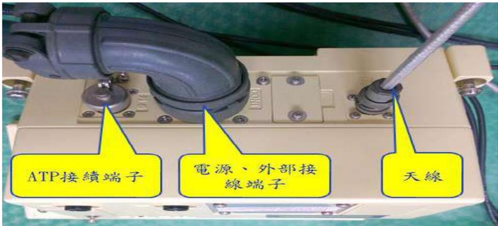
圖 3 列車防護無線電移動台設備示意圖(後端)
