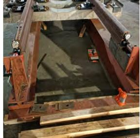
為確保伸縮接頭功能正常，將伸縮接頭組裝於測試架上，以千斤頂施加壓力並以壓力表確認多大的壓力可使尖軌及受軌產生相對運動
