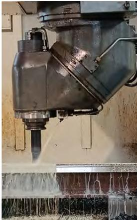
透過 CAD/CAM 軟體設計好加工路徑，CNC 龍門加工中心機作曲面加工，順利完成伸縮接頭研製
