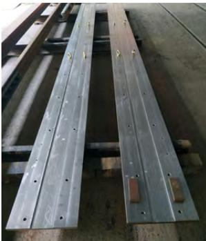
彎製好的鋼軌放置於檢具上只要完全落在凹槽內，表示其彎製曲線為正確
