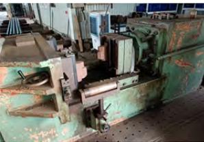
採用油壓彎軌機進行鋼軌彎曲作業
