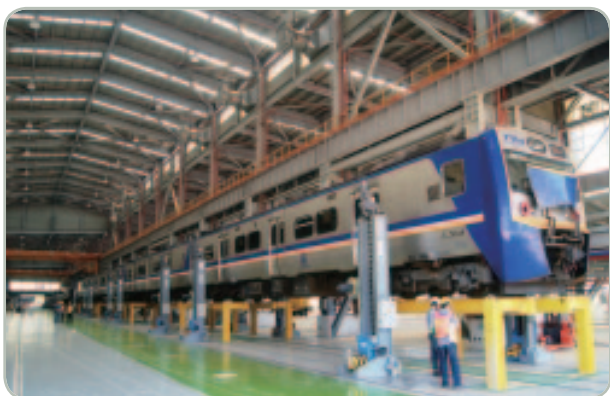
電聯車體工場 (二)- 頂升設備測試 EMU Body Workshop (II) Jack Lifting Equipment Testing
