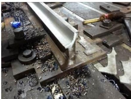
圖 32.輪緣線刨削作業
