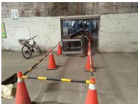
圖 31.刨削作業尾端防護欄
