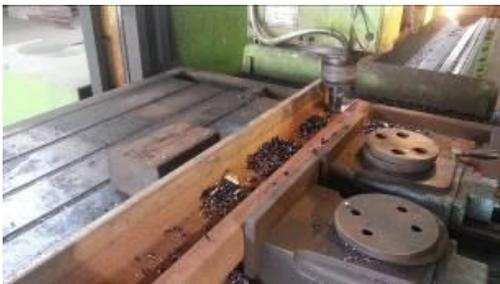
圖 17.螺栓固定槽銑削作業
