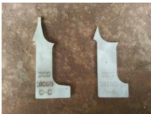
圖 27. 斷面尺寸檢規
