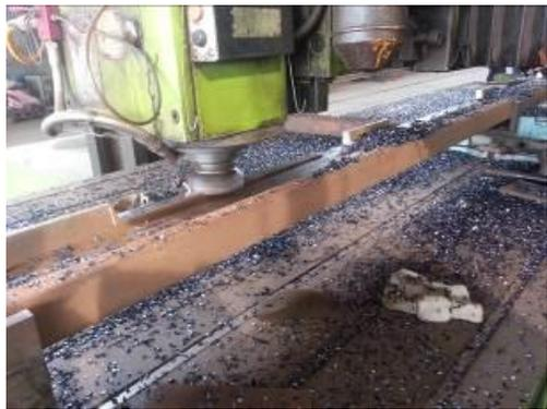
圖 23. 軌底銑削作業
