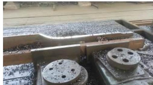
圖 18.軌底趾端銑削作業
