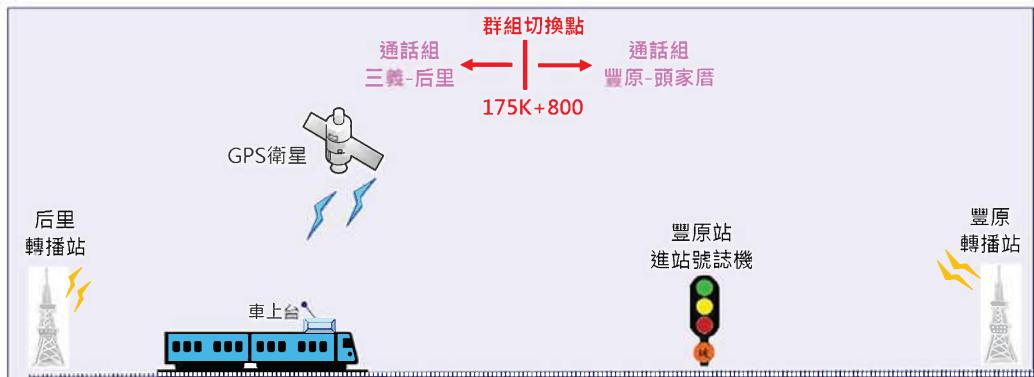
圖 26 群組切換運作示意圖
