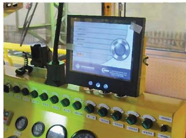
圖 24 第二代車上台操作介面
