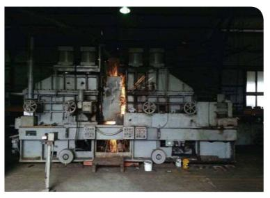
▲電阻火花焊軌機焊接作業
