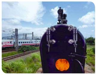
▲ CK101 蒸汽火車鍋爐升溫、試壓程序
