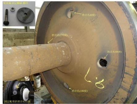
圖 4 一體車輪消音孔角度位置
