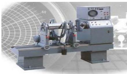
應用於馬達，發電機，排風機，送風機，引擎，幫浦，工作機械，農業機械，製紙機械，紡織機械，建築機械，食品機械，汽車，機車，輪船，飛機等各種機械之回轉機件及組合後之平衡試驗及修正<sup>[5]</sup>。
