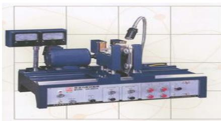
應用於轉輪、飛輪、齒輪、砂輪、離合器、扇葉、吊扇等圓盤形迴轉體之測定及修正所設計之平衡試驗機<sup>[5]</sup>。
