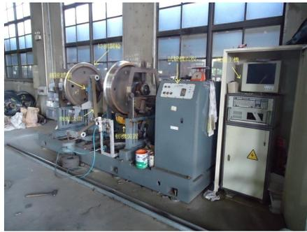
圖 1 動態平衡測試機全景圖
