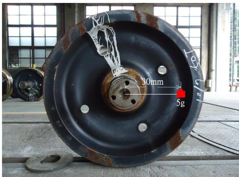
圖 6 轉動矩不平衡量示意圖
