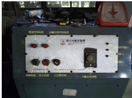
圖 3 動態平衡測試機控制箱
