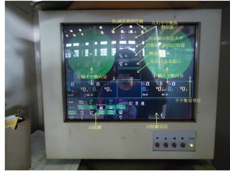
圖 2 動態平衡測試機電腦主機顯示器畫面
