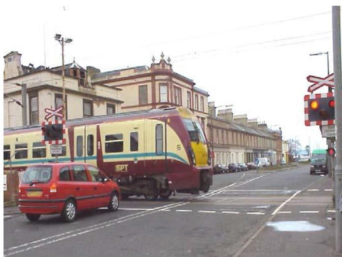
圖5、自動開放式就地監控式平交道(AOCL)
