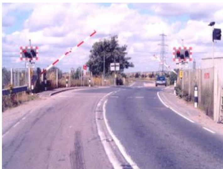
圖4、自動就地監控遮斷式平交道(ABCL)
