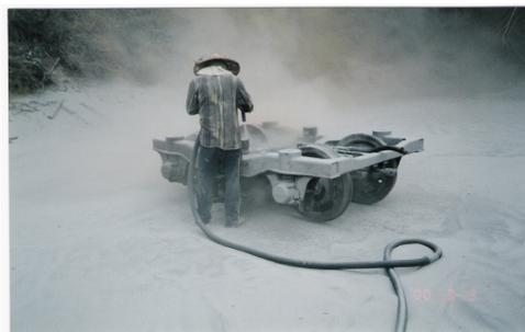
圖 31 轉向架噴砂防銹處理
