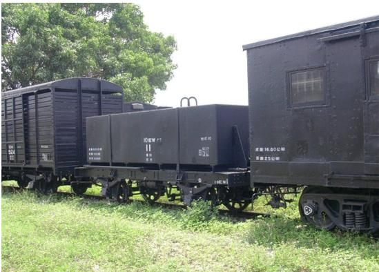
車籍 10EW11 水櫃車，1931 年由日本製造，它是以前蒸汽火車後面的煤水車改造而成。其特色為車身最短，其尺寸規格 6,286mm\*2,100mm\*2,863mm，作為蒸汽火車蒸汽動力來源供應之設備用車，於 1995 年 11 月 7 日功成身退。由於其造型具特色，甚具有保存價值，經指定為鐵路文物車，由臺鐵局機務處高雄機廠整修，以作為永久之保存。
