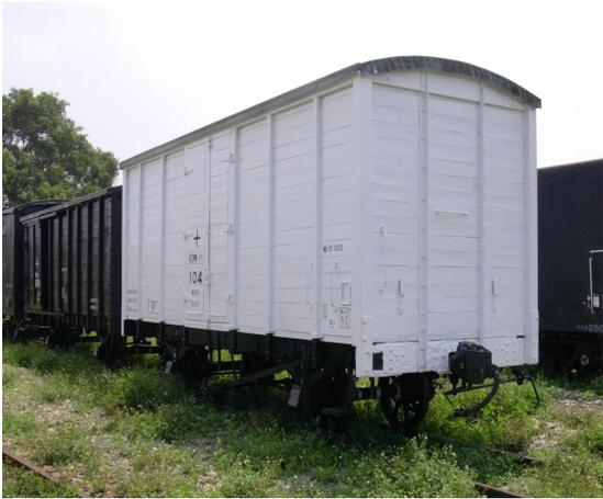
車籍 10R104 冷藏車，1928 年由日本製造，日據時代載運需要冷凍保鮮的肉品、鮮魚及水產食品，而特別製造的貨車。其特色為車身上有 (+) 標記，表示無氣軔裝置，只有氣軔管連接前後車輛，有踏軔機構在停留時可防止溜動，以及溜放時作為煞車用。另一特色為全白的車身，鋼製的車體，在眾多黑色的貨車族群中十分醒目，於 1984 年 6 月 30 日功成身退。由於其造型具特色，甚具有保存價值，經指定為鐵路文物車，由臺鐵局機務處高雄機廠整修，以作為永久之保存。
