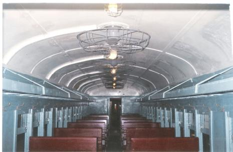
圖 11 完成後之內部設備與照明、電扇
