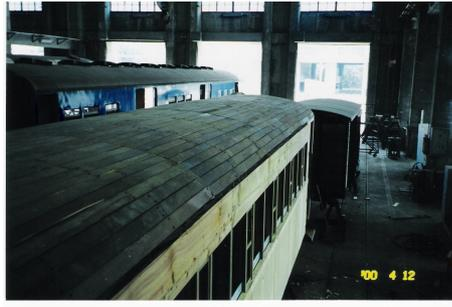
圖 38 車頂板之搭樺施工過程
