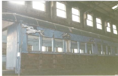
圖 10 拆除車廂外木板
