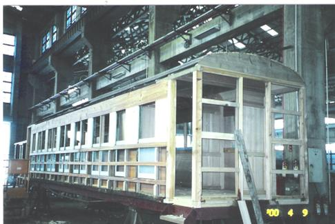
圖 37 落下式之階段窗戶設備
