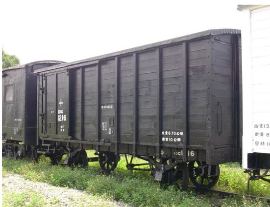
車籍 10C1216 篷車，1920 年由日本製造，日據時代載運貨物 10 噸之木造篷車。其特色為車身上有 (+) 標記，表示無氣軔裝置，只有氣軔管連接前後車輛，有踏軔機構在停留時可防止溜動，以及溜放時作為煞車用，於 1992 年 8 月 26 日功成身退。由於其造型具特色，甚具有保存價值，經指定為鐵路文物車，由臺鐵局機務處高雄機廠整修，以作為永久之保存。
