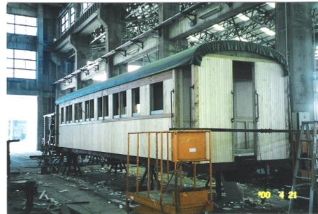
圖 39 車廂外觀與車頂布之施工
