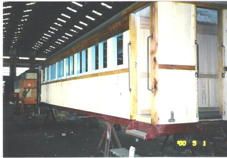
圖 40 上下台雨簷施工
