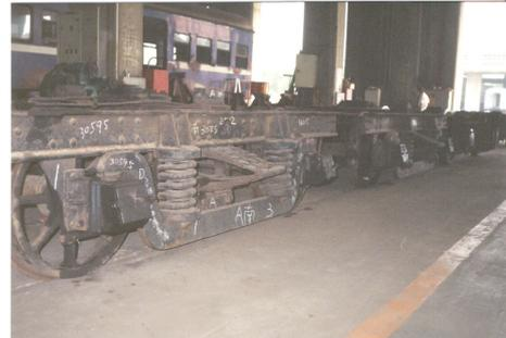
圖 12 TR15、16 型轉向架整修
