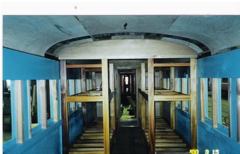
圖 28 臥鋪施工過程
