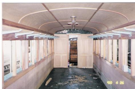
圖 36 車廂內幕牆板施工過程
