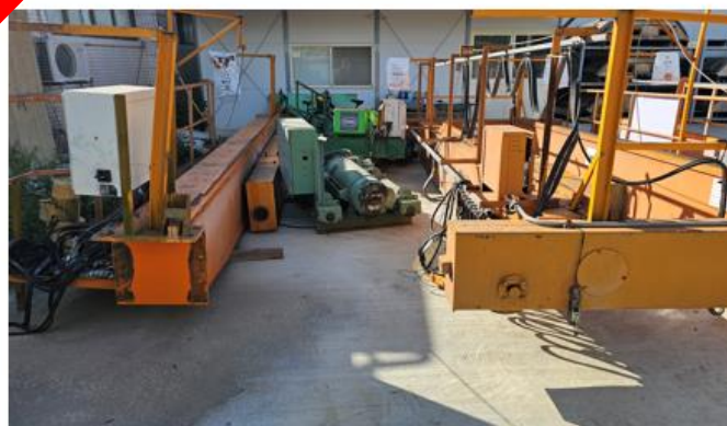
廢 15 噸固定式起重機 1 台(已拆解、跨距 6 米)
