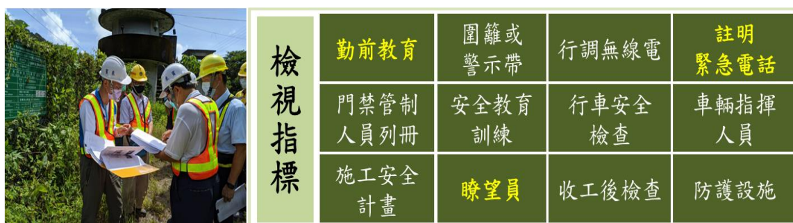
圖 1 臺鐵臨軌在建工程 12 項檢視項目
