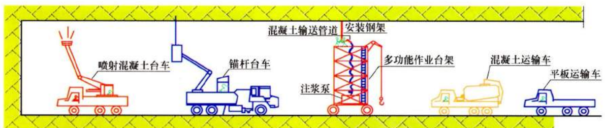
圖 4.1-10 隧道施工機械化作業(岩錨.掛網.噴漿)
