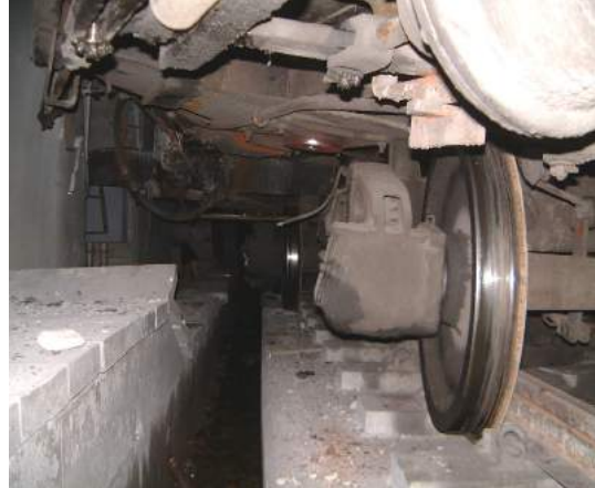
(照片 9-8) 734 次散裝水泥車出軌
