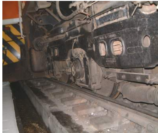
(照片 9-4) 734 次機車撞擊 896 次 R192 前軸出軌情形
