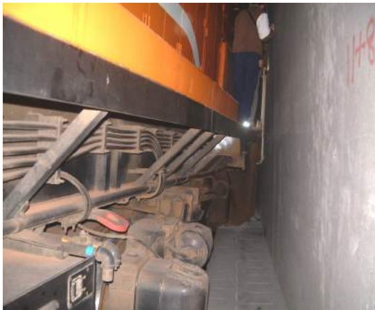
(照片 9-3) 734 次重聯機車撞擊 896 次 R188 後軸出軌情形
