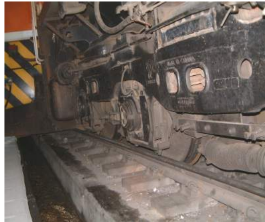
(照片 9-4) 734 次機車撞擊 896 次 R192 前軸出軌情形
