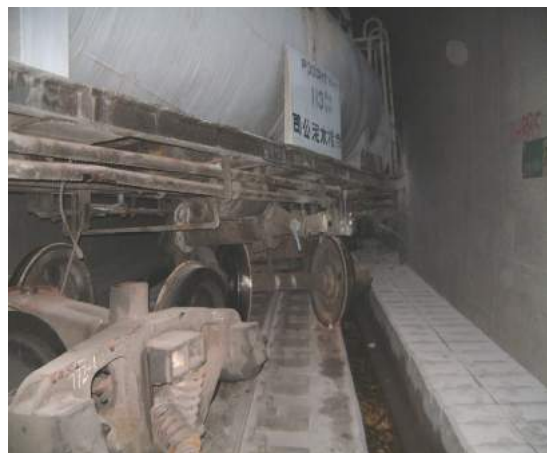
(照片 9-6) 734 次散裝水泥車全軸出軌情形
