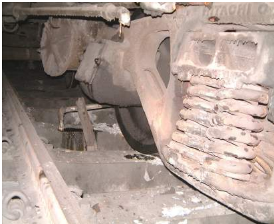
(照片 9-9) 734 次散裝水泥車出軌情形
