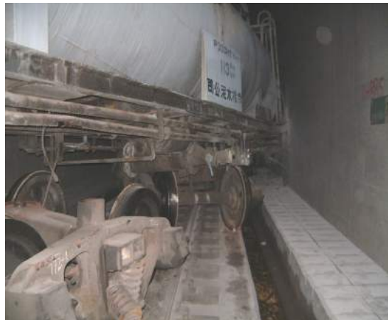
(照片 9-6) 734 次散裝水泥車全軸出軌情形
