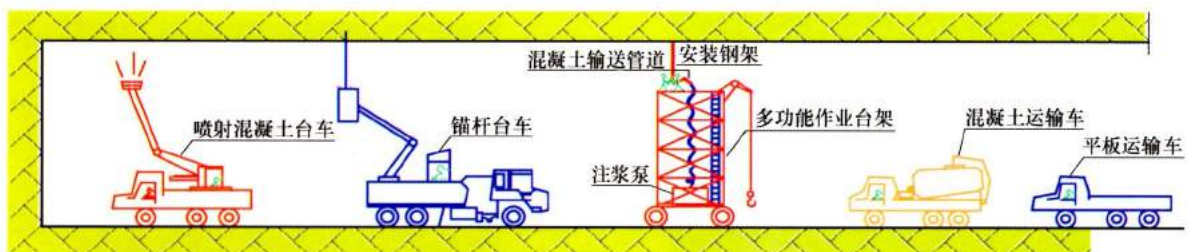
圖 4.1-10 隧道施工機械化作業(岩錨.掛網.噴漿)
