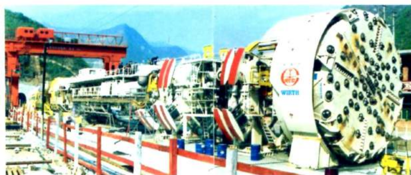
照片 4.1-2 隧道鑽掘機 TBM (tunnel boring machine)
