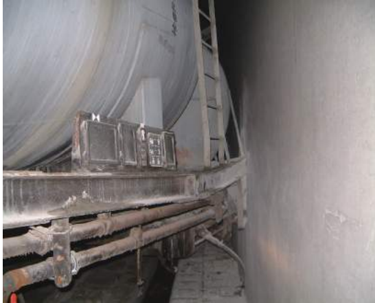
(照片 9-7) 734 次散裝水泥車出軌情形
