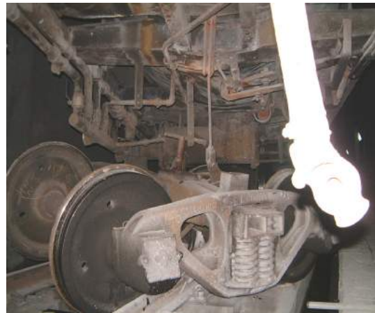
(照片 9-10) 734 次散裝水泥車出軌情形
