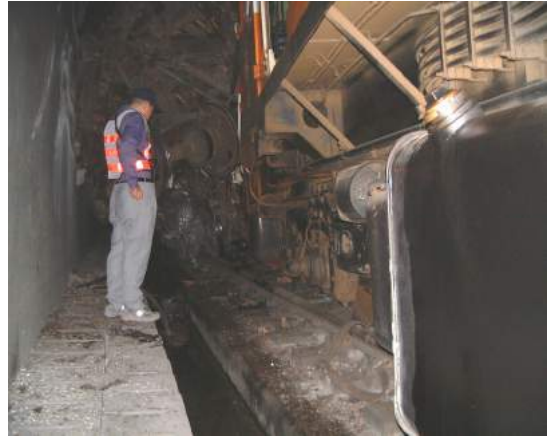
(照片 9-2) 734 次機車撞擊 896 次 R188 前軸出軌情形
