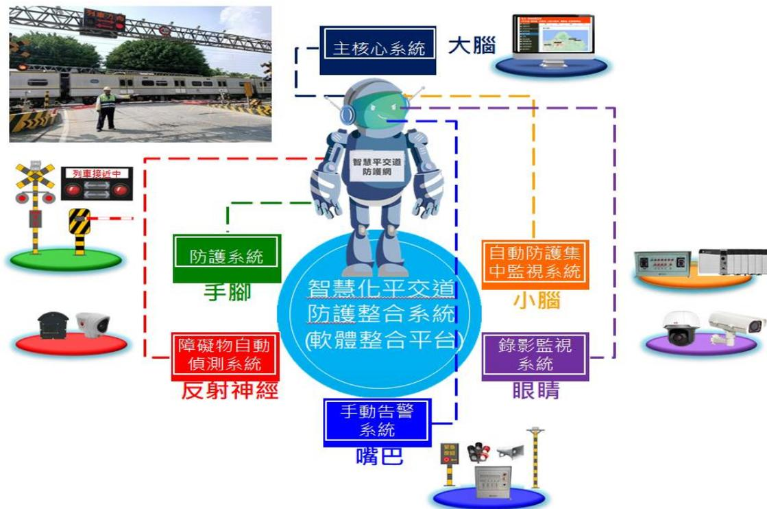
圖 6 臺鐵智慧平交道防護系統
